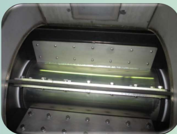
ゴムチップ型 ・塊状物の嚙込を防ぎ排出可能な状態を保持
