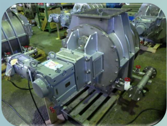
直結型 ・各ロータリーバルブに必要に応じて組合せ可能
